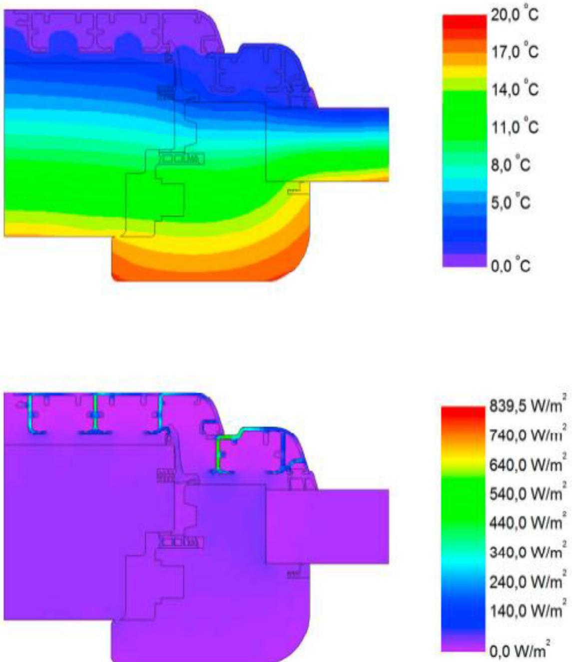
Fig. 6. Andamento delle temperature e dei flussi di calore nel nodo 02
